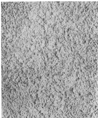
Kuva 60. Laudalla suoristetun alusrappaoksen päälle on lyöty vetelä hienolaasti, johon on lisätty pieniä kiviä. Soveltuu ulkoseinien rappaukseen.
