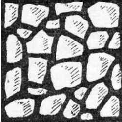
Kuva 153. Oikein tehtyä säästöbetonia. Jokainen kivi on betonilaastin ympäröimä.
