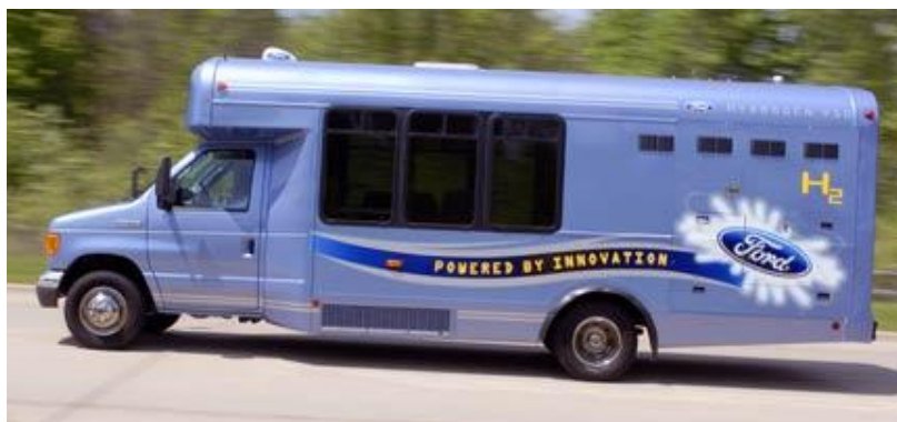
Fordin vetykäyttöinen polttomoottoritekniikkaan perustuva minibussi E450.
